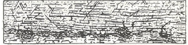
Şekil 4 — Cevherli dolomitin aşağı metozomatik kenarı boyunca gelişen çökel dolgulu boşlukların üst kısmında başlangıç halindeki breşleşme ve kırılma.
